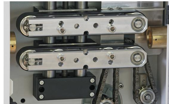
Materialzuführgeräte von Metzner kommen überall dort zum Einsatz, wo Materialien von einer Vorrichtung ohne Antrieb abgewickelt werden. Das betrifft zum Beispiel Kabel- und Profilrollen, Spulen, lose Ringe oder die Verarbeitung direkt aus einer Box oder einem Kabelregal.
