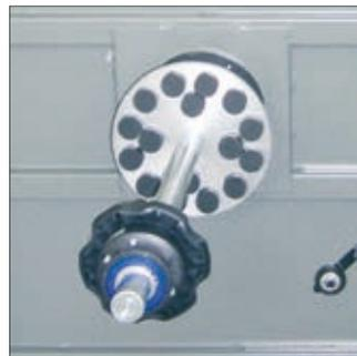
Abb. 3 Spulnwickelachse
