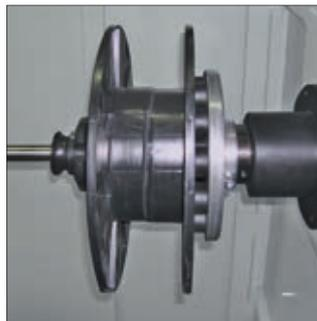
Abb. 3 Spulenwickelachse
