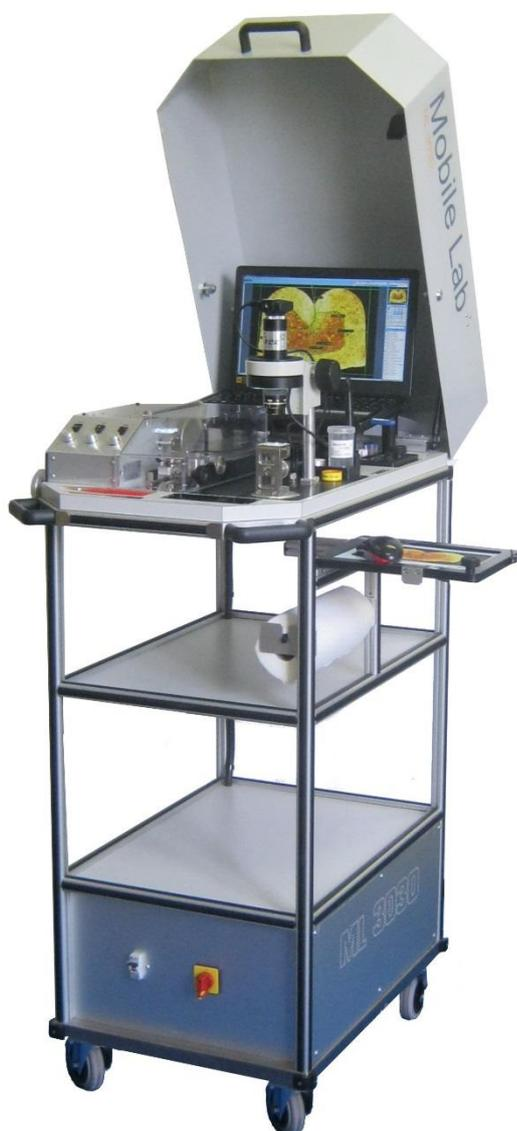
Das mobile Schliffbildlabor ML3030 wurde konzipiert, um die Anforderungen einer schnellen und präzisen Herstellung von Crimpschliffbildern im Fertigungsbereich zu erfüllen. Durch seine mobile Bauweise und Akkubetrieb kann das Mobile Lab ML3030 flexibel überall im Fertigungsbereich eingesetzt werden.
