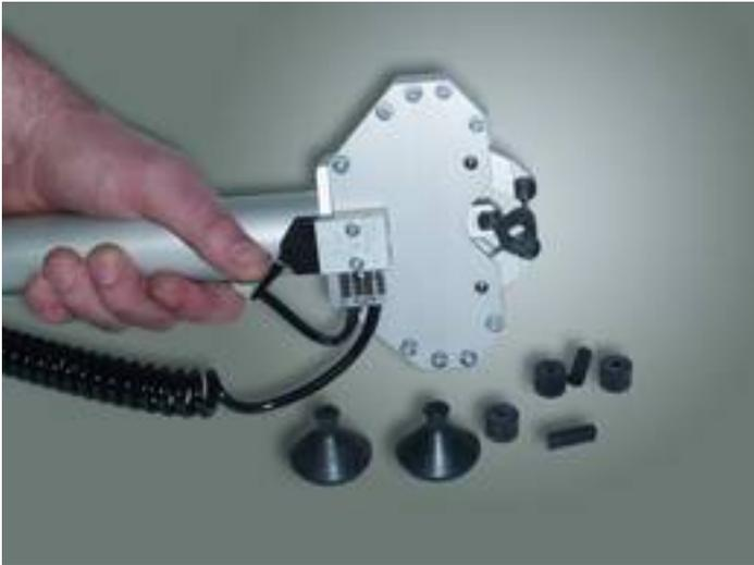
Flexible Tüllen können mittels dieser Dreidornvorrichtung gespreizt werden.
