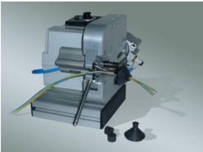
Durch die Aktivierung der **Pull-Off Unit** wird die Tülle prozesssicher auf den Leitungssatz / Schlauch abgesetzt.
