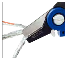
Schneiden der Paarschirmung Cutting the double shielding
