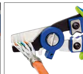
Schneiden der Innenleiter Cutting the conductors
