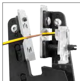
Abisolieren durch Formmesser Stripping with profile blades
