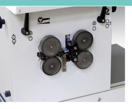
Der Abläng- und Abisolierautomat Metzner AM 2000 bearbeitet Drähte und Litzen präzise und wiederholgenau. Für alle Industriebereiche, in denen Prozesssicherheit, Flexibilität und schnelle Fertigung, kürzeste Rüstzeiten und Bedienerfreundlichkeit gefordert werden, steht mit der AM 2000 eine in dieser Preisklasse einzigartige ausgestattete Maschine zur Verfügung.
