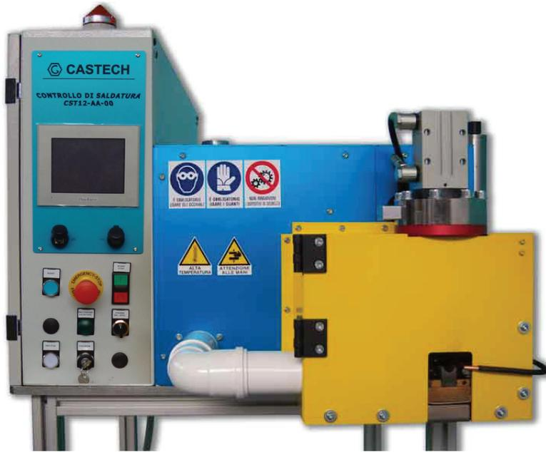
Die Maschine GFA301000 wurde für die Verbindung zwischen Lackdrähten und Kabel in den Elektromotoren entwickelt, gemäß einer Logik halbautomatischer Arbeitsverfahren, indem neben dem Anspruch auf Beständigkeit und Zuverlässigkeit des Prozesses auch auf Eigenschaften wie Einfachheit, Flexibilität und erhöhte Produktivität geachtet wurde, um so das beste Ergebnis in Bezug auf Konsistenz und Reproduzierbarkeit zu erhalten.
